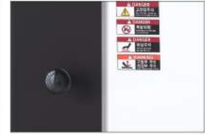
수동 스팀밸브손잡이 스팀밸브손잡이를 돌려 강제로 Autoclave의 스팀을 빼낼 수 있습니다. (작동 중 스팀밸브를 열면 매우 위험하며, 스팀밸브가 열려 있으면 압력이 올라가지 않습니다.)
